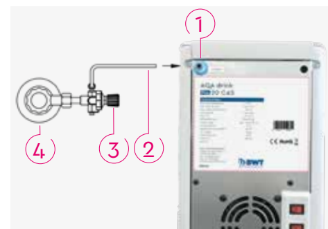
Рис. 11: Подключение баллона со сжатым CO 2
